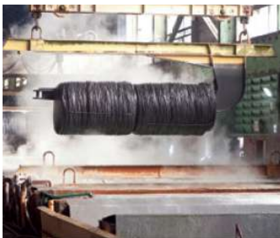
Foto 1 – Processo de decapagem de fio máquina
